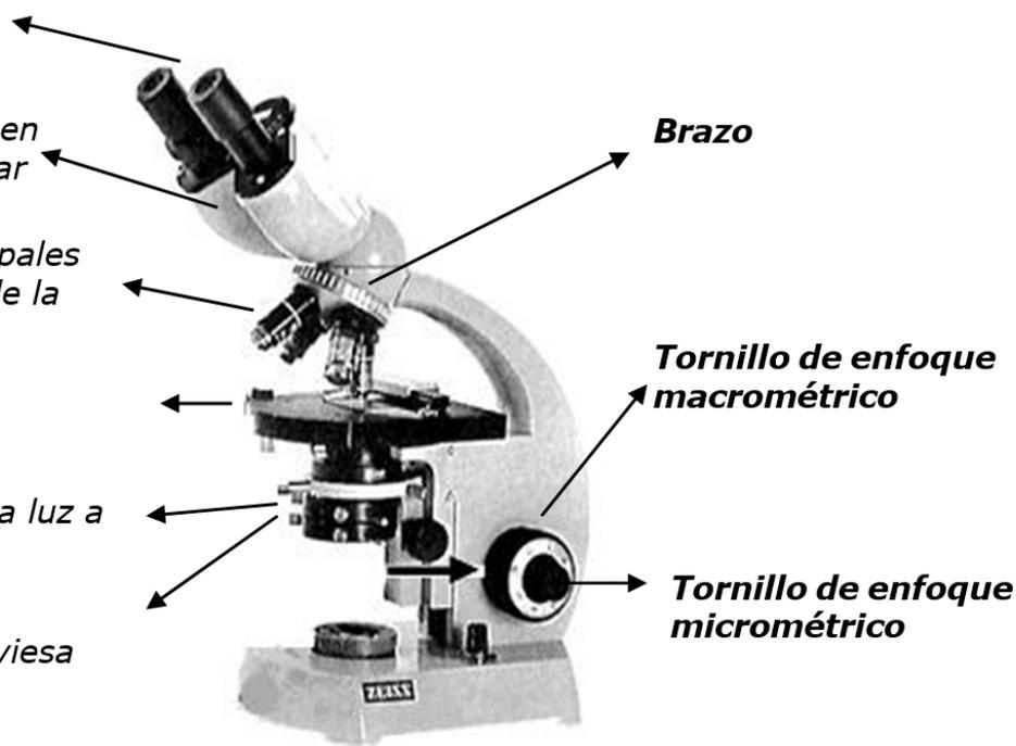
Figure 2.2.1: Microscopio óptico compuesto. Partes principales y funciones. (CC-BY; This work)
